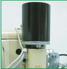
采用电磁直驱式传动机构,力量直接输出,容易调整。
