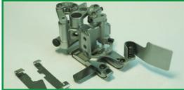
采用弹片式压脚机构,针对不同面料量身定制不同的压脚皮,使内衣用薄料及高弹性面料均能充分应对。
